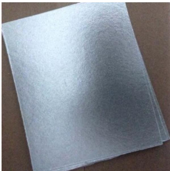
Las placas de mica son un estratificado a base de papel de Mica impregnado con resinas. Sus principales características son que tiene una temperatura de trabajo hasta de 800 °C, autoextinguible y baja absorción de humedad.
