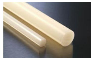
El PVDF (Fluoruro de Polivilideno) es un termoplástico altamente cristalino. Mantiene sus propiedades eléctricas, térmicas y mecánicas en un amplio rango de temperaturas (-40 a 150°C). Resiste muy bien la intemperie y especialmente las radiaciones UV y los rayos Gamma.
